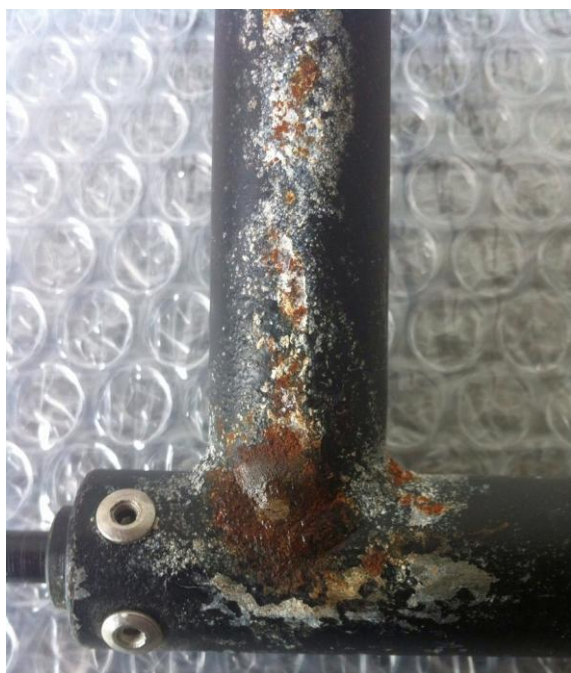
Obrázok 1 – Korózia a prasknutie zvaru rúrkovej konštrukcie padála nožného riadenia Figure 1 - Corrosion and rupture of the weld of the tubular structures of the foot pedal control
